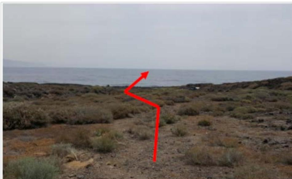
La longitud total de la conducción de alivio al mar será de 325 m y está determinada por la necesidad de llegar hasta la profundidad de al menos 8m. 107,74m corresponden al tramo terrestre entre la arqueta de cabecera del emisario y la línea de costa; y 217,26m corresponden al tramo entre la línea de costa y el punto de vertido.
