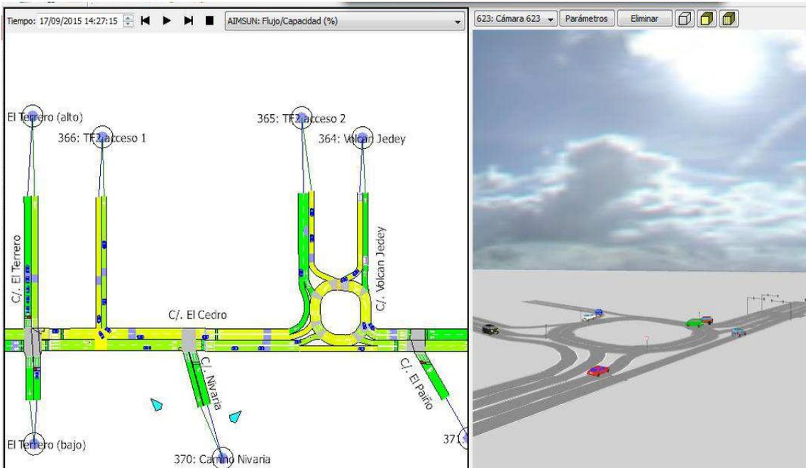
Figura 4. Simulación de la propuesta (rotonda).
