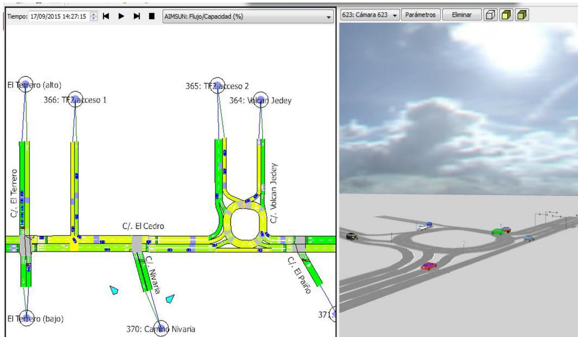
Figura 4. Simulación de la propuesta (rotonda).
