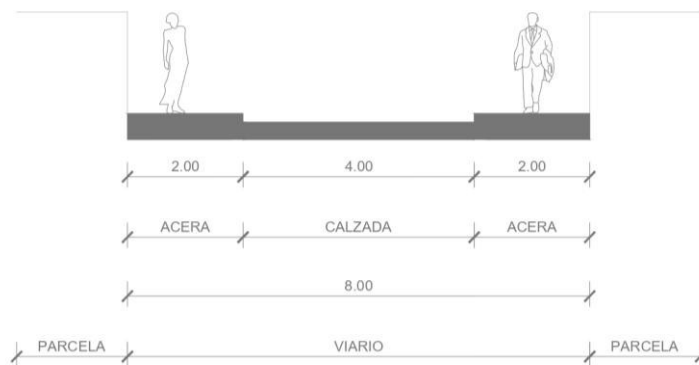
Imagen: Sección tipo de la vía interior propuesta. Alternativa 0. Elaboración propia
