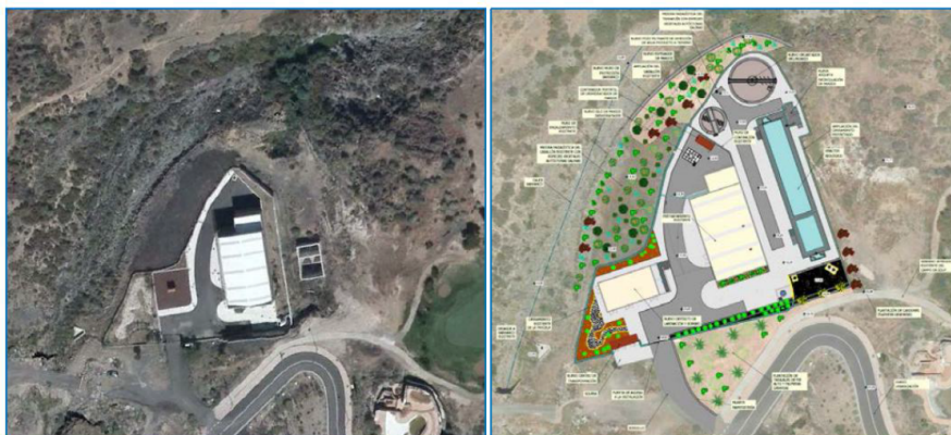
Imágenes 12 y 13. Vista de la ETAR de Amarilla Golf existente (izqda.) y de la ETAR+EDAR transitoria proyectada (dcha.). Fuente: CIVILPORT Ingenieros, S.L.P.
