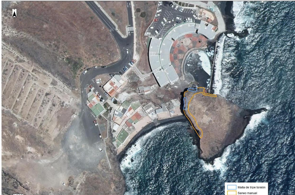
Imagen 85. Medidas previstas para reducir los riesgos por desprendimiento en el Roque de Dentro
