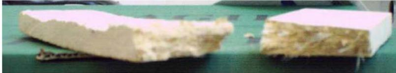
Fig. 5 Imagen de probeta de GLASSYDUR rota.
