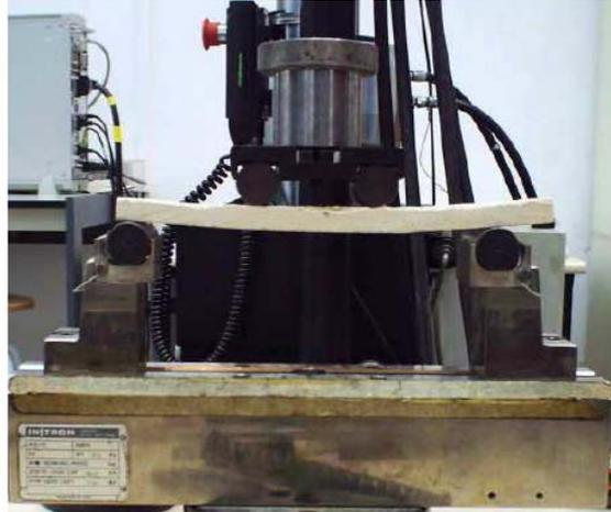
(1) El panel sandwich en este caso se compone de una lámina de GLASSYDUR de 10 mm de espesor, una capa de poliestireno expandido de 110 mm. y otra capa de GLASSYDUR de 10 mm de espesor.
