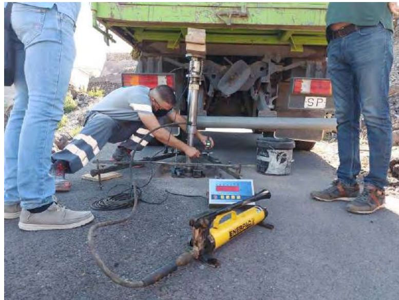
Ilustración 7: Prueba de carga Pk 1+190 (según acta de ensayo "Placa nº1" del 06/05/2021).
