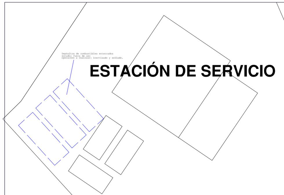
**OPERACIÓN DE INERTIZADO DEPÓSITOS DE COMBUSTIBLES EN ESTACIÓN DE SERVICIO. ESCALA 1:125**
