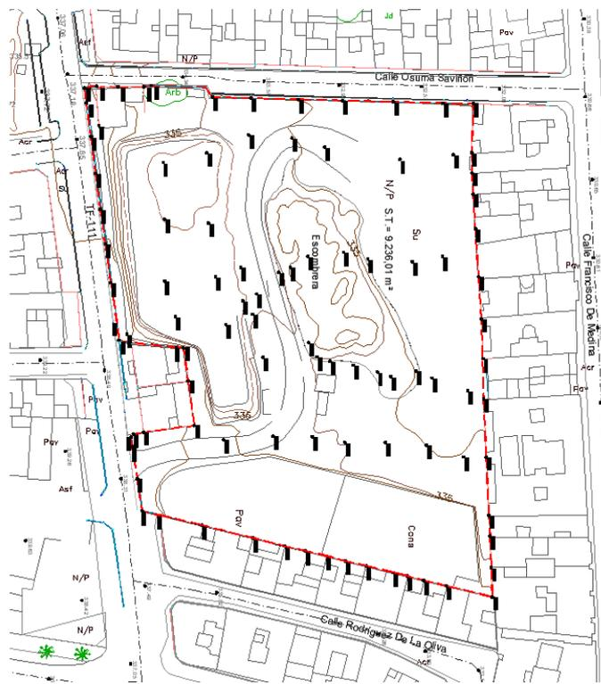
Ilustración 3 Levantamiento topográfico del ámbito
