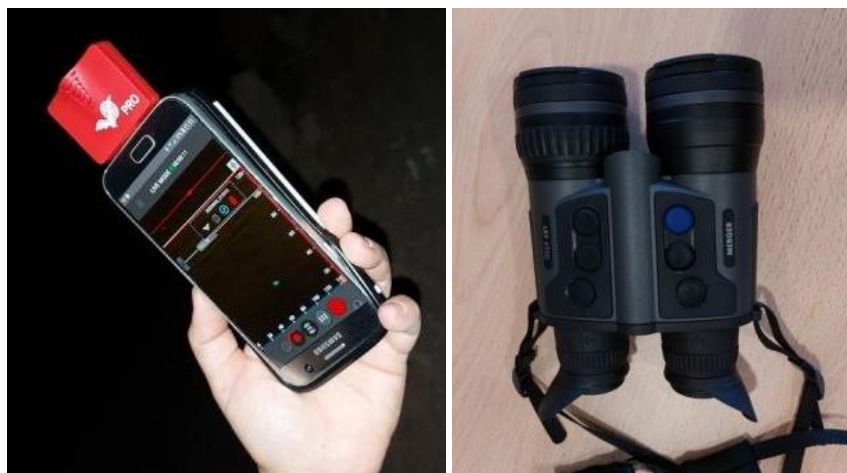
A la izquierda, módulo ultrasónico y a la derecha prismáticos térmicos, material empleado para la detección de murciélagos.
