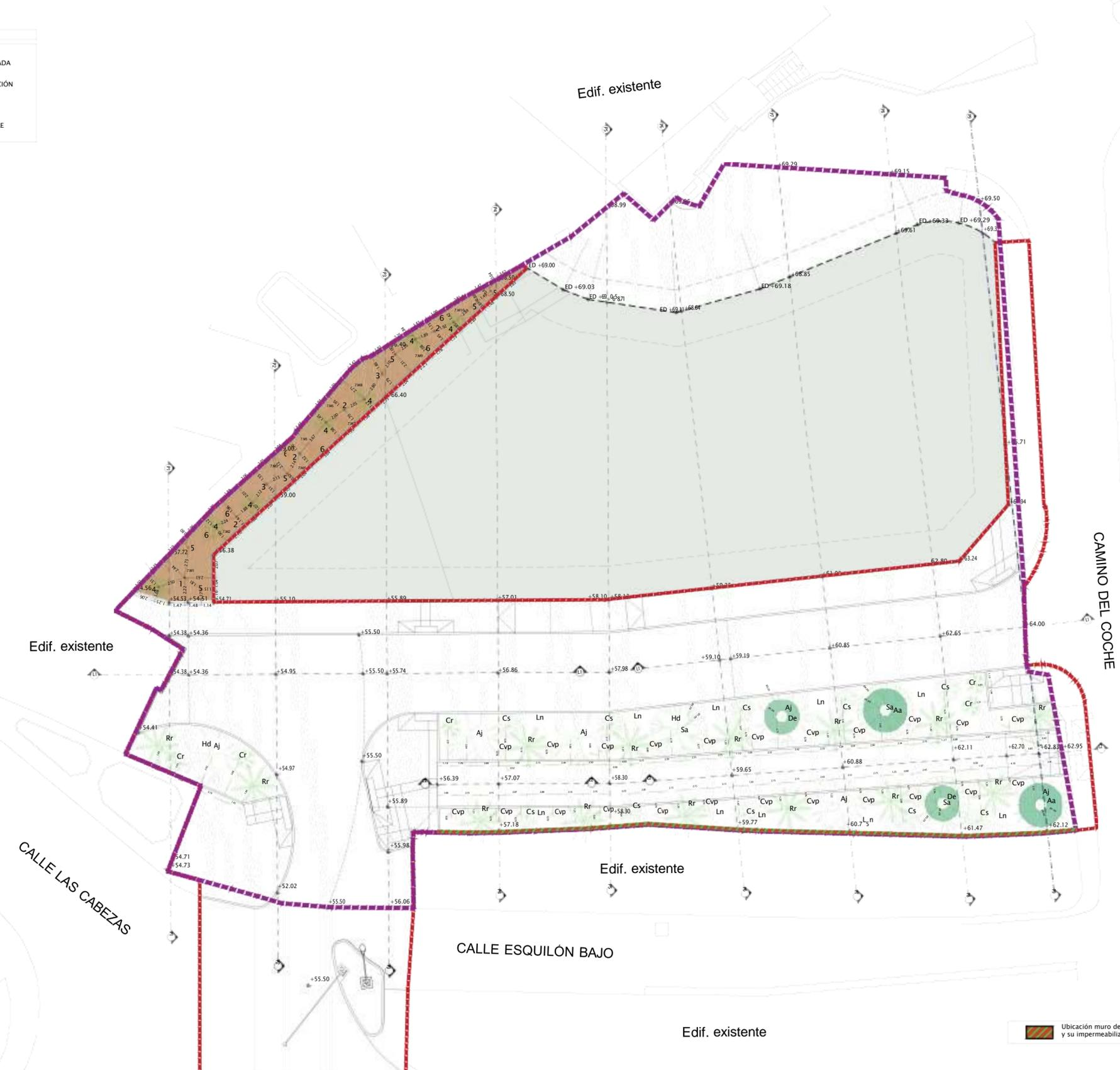
Ubicación muro de contención (Partida D07AA0020) y su impermeabilización (Partida D09E0500)
