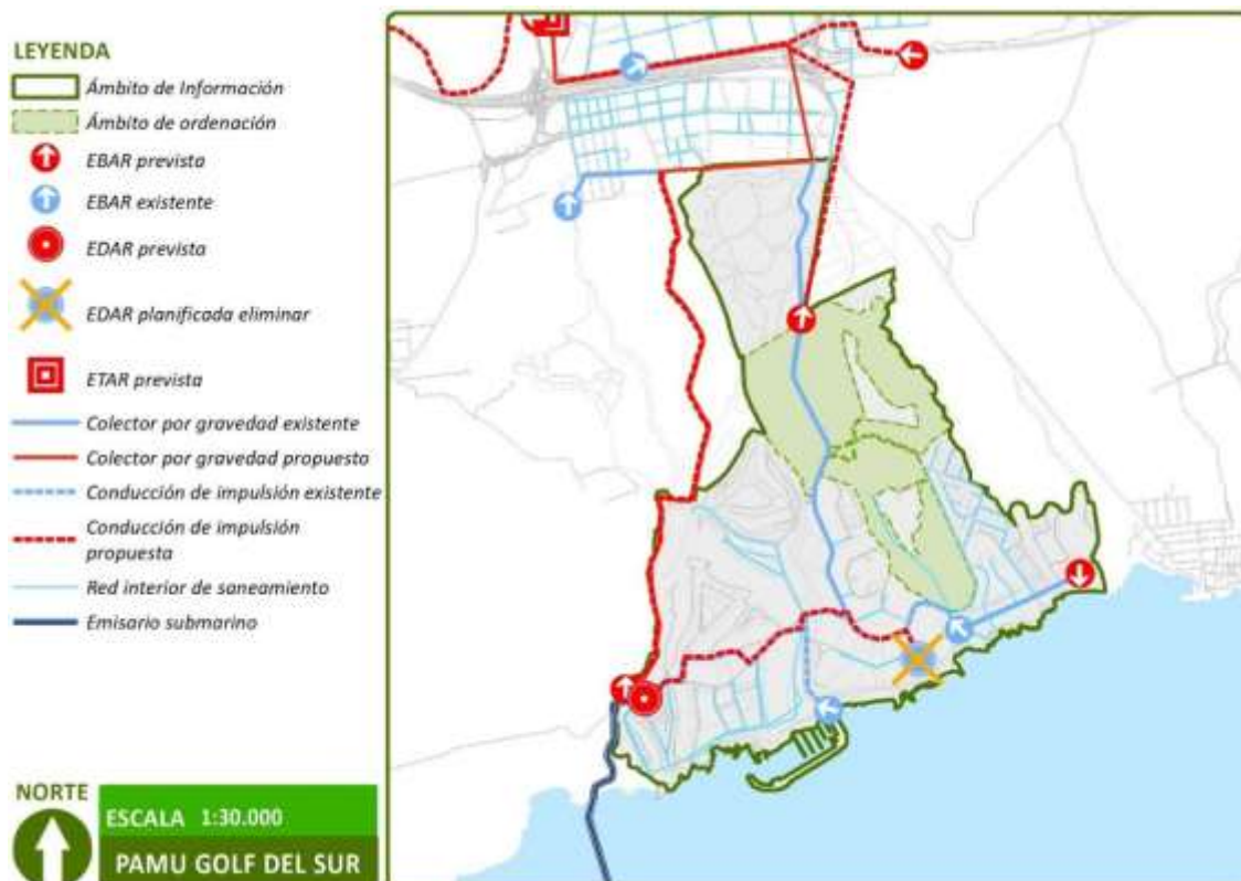
Red de saneamiento de agua en Costa San Miguel. Elaboración propia
