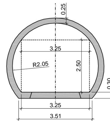
SECCIÓN TIPO GALERÍA CONEXIÓN
