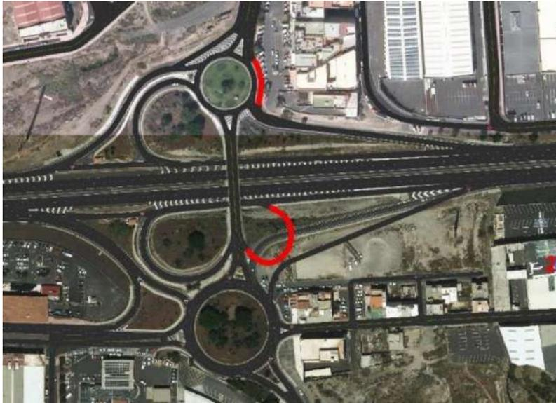
**Figura 15 Modelo M01b Nuevo ramal tipo lazo y carril segregado hacia San Miguel**
