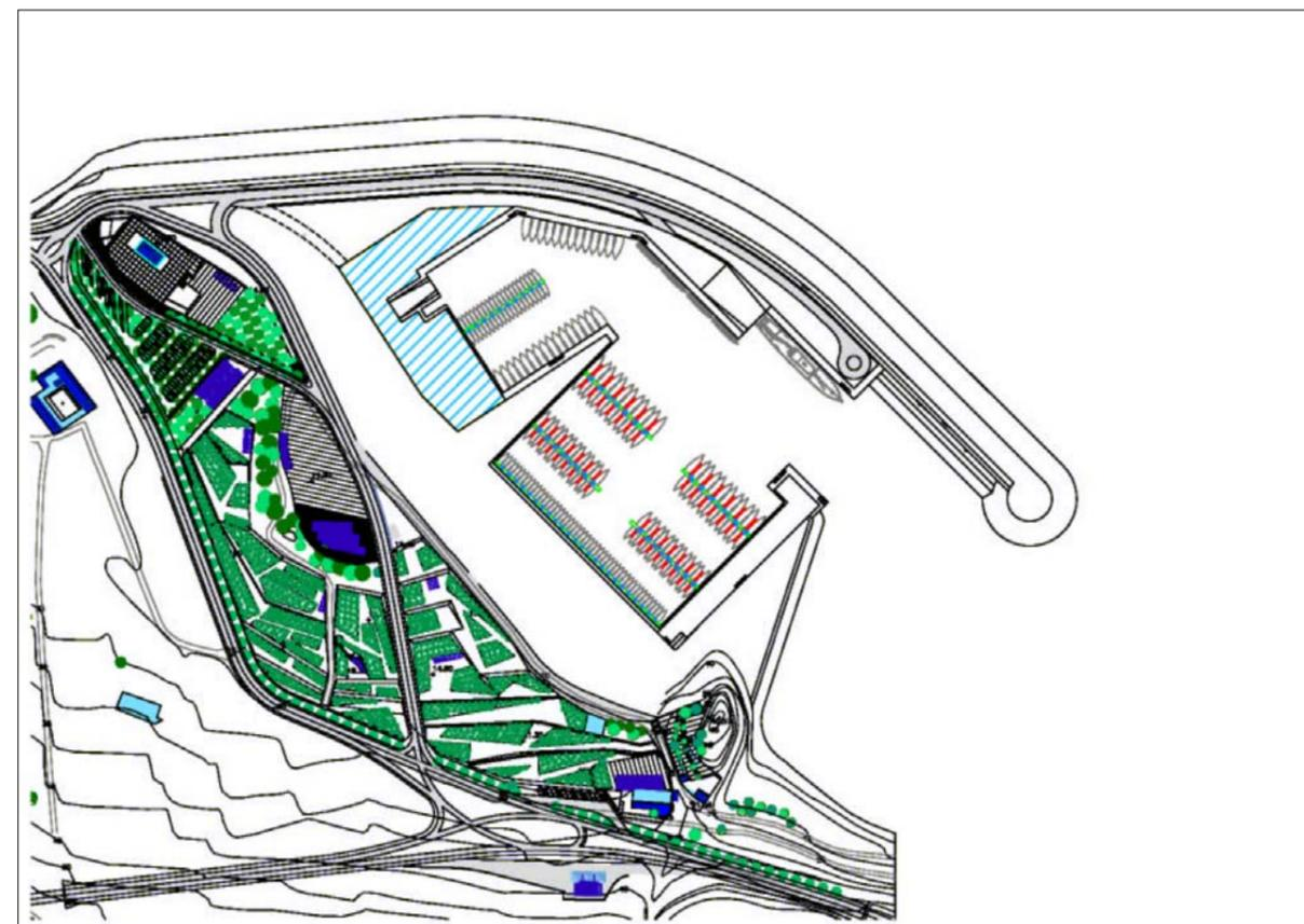
En la dársena pesquera, con 9.500 m<sup>2</sup>, se emplaza un pantalán para las pequeñas falúas de pesca (40 uds), y se disponen asimismo tres muelles de 230 m de longitud en total: 70 m para muelle de carga y descarga, y 160 m para 29 atraques de los barcos mayores. Adosada a esta dársena, se ha contemplado una zona de tierra diferenciada para las labores de este gremio, instalación de los almacenes, pertrechos, lonja, etc. y para la rampa de varada, hueco de travelift y marina seca.
