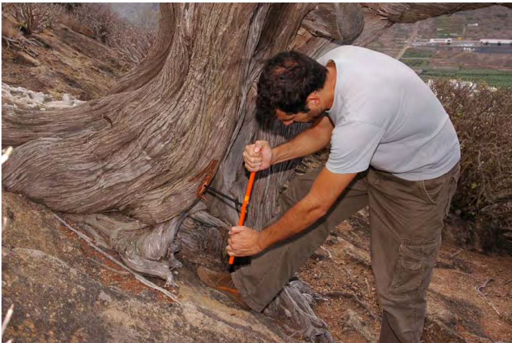
Fotografía 1.1: Perforación del tronco, paralelo a la pendiente usando una barrena de 40 cm de longitud.
