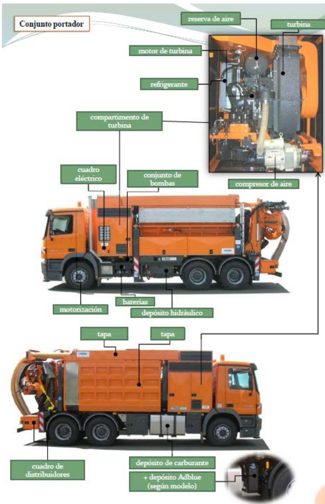
*Imagen del camión zanjador*
