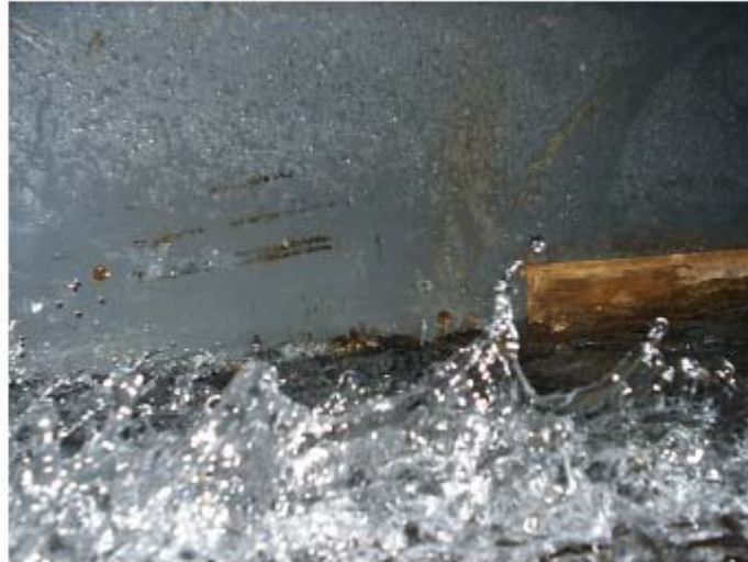
Figura 5.3: Reja BARCINO bajo condiciones de ensayo
