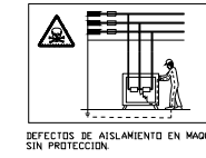
DEFECTOS DE AISLAMIENTO EN MAQUINAS SIN PROTECCION.
