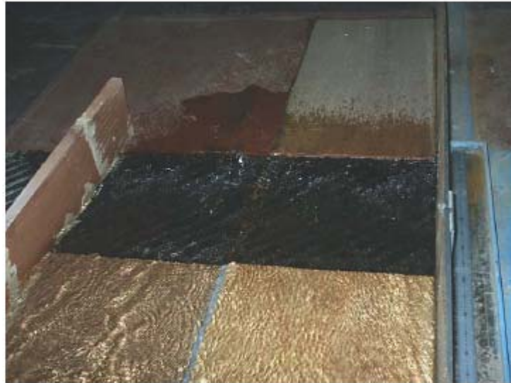
Figura 6.1: Reja BARCINO transversal bajo condiciones de ensayo ( I_x=0\% )
