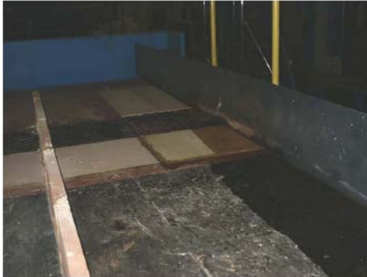
Figura 4.2: Limitación de la zona de ensayo (1 m x 5.5 m)
