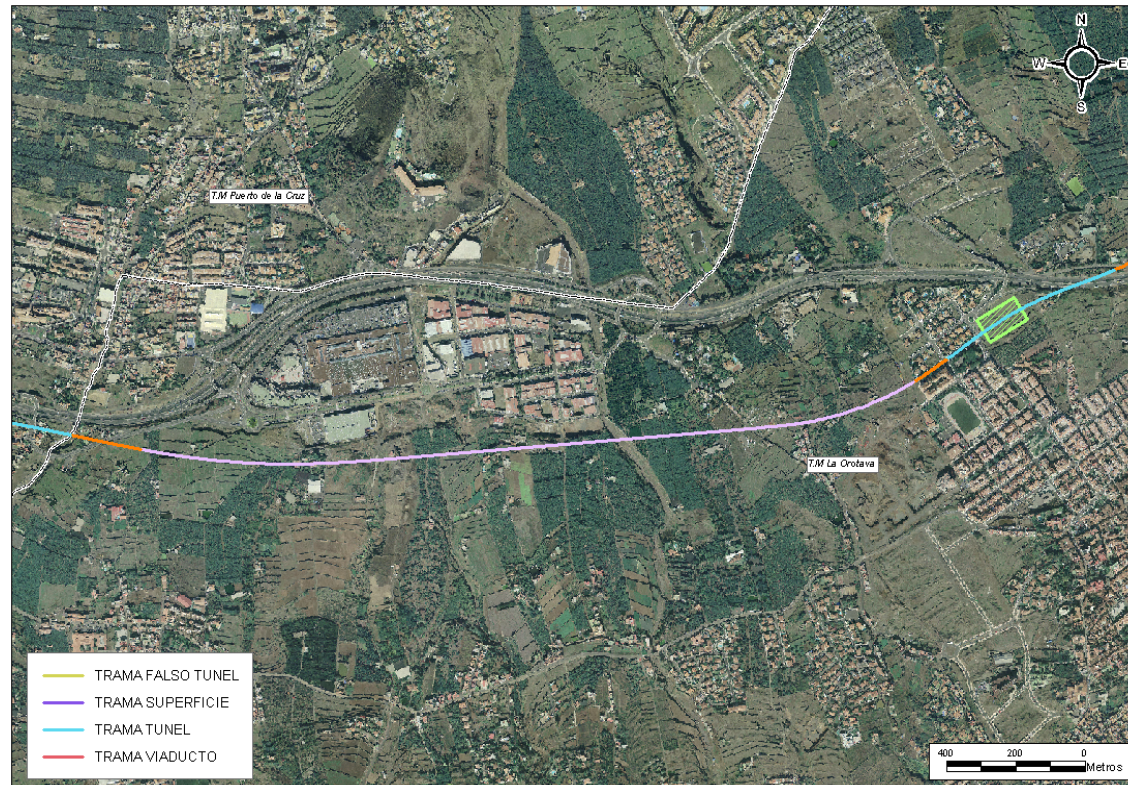
Ilustración 6.17 -Trazado preliminar de la alternativa seleccionada sobre parte del término municipal de La Orotava
